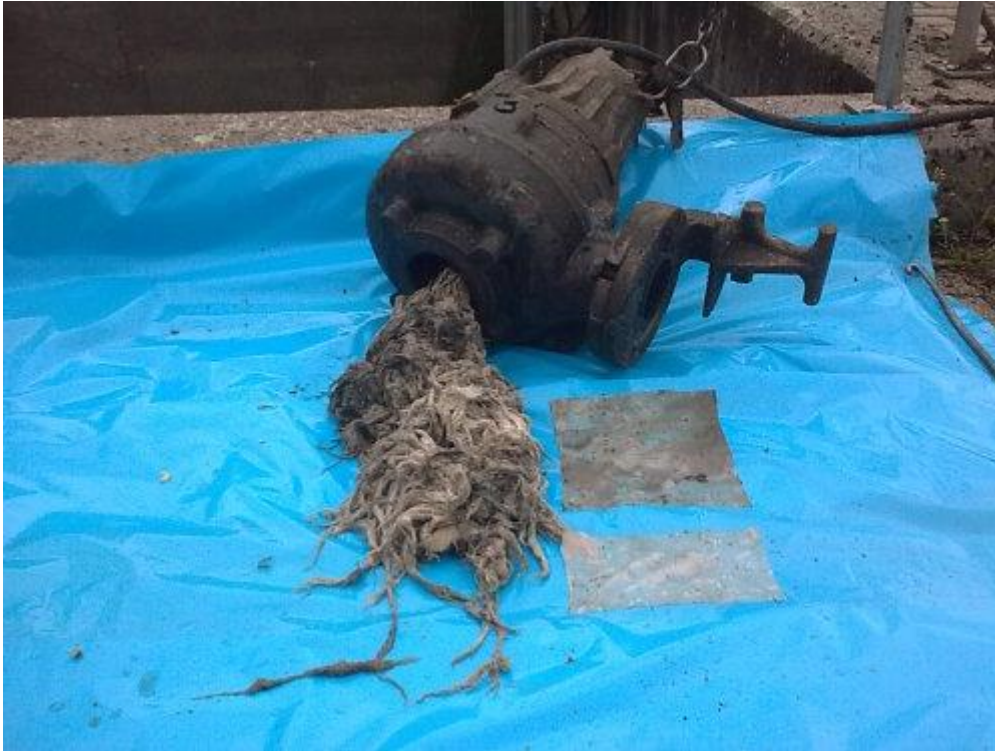
Pumpe der KA-Ziegelhütte mit einem Zopf aus Feuchttüchern
